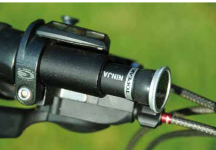
Nýtovačku řetězu schovává Jirka v řídítkách.
